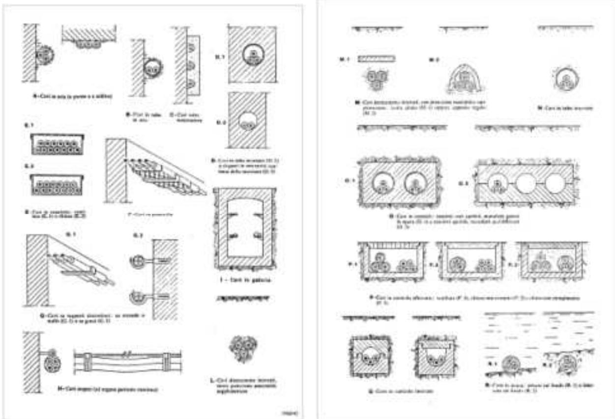
Si adatterà il tipo di posa “M” indicato dalla CEI 11-17; lo scavo dovrà essere minimo di 0,5 m sopra tubo per i tratti ordinari e 1 m per tutti gli attraversamenti stradali. All’interno dello scavo, posto al di sopra delle condutture, dovrà essere stesa una apposita segnalazione a nastro indicante la tipologia di impianto e la tensione di esercizio “condutture elettriche 400V”.
