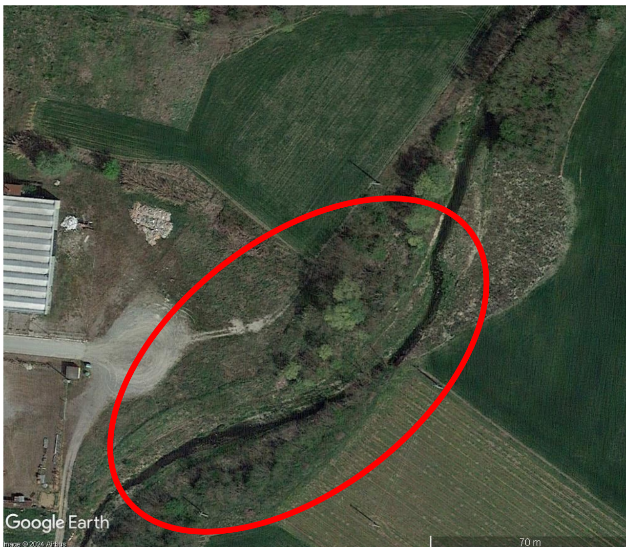
Figura 12-1 - Sito dell'Intervento 3 ove venne realizzato l'Intervento L del progetto del Comune di Canneto (COMUNE DI CANNETO PAVESE, 2012) ovvero l'intervento 11.b dello studio generale (COMUNE DI CANNETO PAVESE, 2011). Situazione a marzo 2022. La corrente di magra ha ripreso l'originario percorso al centro della sezione abbandonando la lunata.
